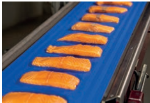
Serie TPU Premium Alimentación. Formulación bacteriostática con efectos antimicrobianos y antibiofilm de larga duración (ISO 22196). Alta resistencia a la Hidrólisis. Tejidos de baja capilaridad (Wicking Test G11-FDA 2011).
